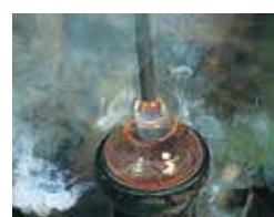
柔らかくなったガラスをグラス型の金型にまわしながら吹き込みます。凸凹のあったガラスの表面が型になじみ、表面はつるつるになります。またその時、型にガラスが触れた温度差により（急冷）、更にオパールが発色し、絵柄が浮かびあがります。
