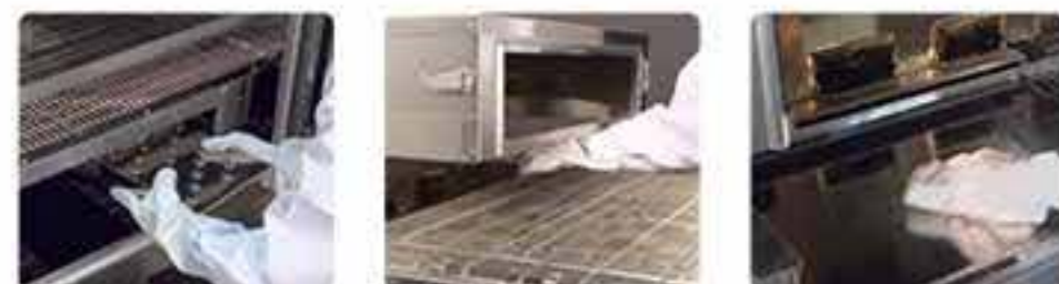
フィンガーを 取り外し コンベアを 手前に引き出す 庫内の奥まで 清掃がしやすい
