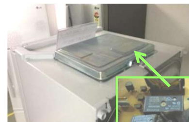
海外の冷蔵庫において、天面に設置された基板や霜取りタイマーへの蟻の侵入問題に対して、対策としてARテープが採用されています。
