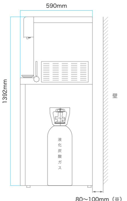
※設置の際は、電源コード及びメンテナンス対応のため、背面に80~100mmのスペースを確保してください。
