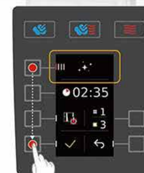
ジョグダイヤルで4段階の洗浄プログラムから 汚れに応じてコースを選択、実行
