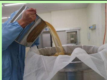
原料をろ過布でろ過し異物除去します。
