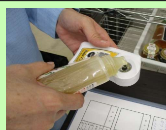
糖度測定などの製品検査をします。
